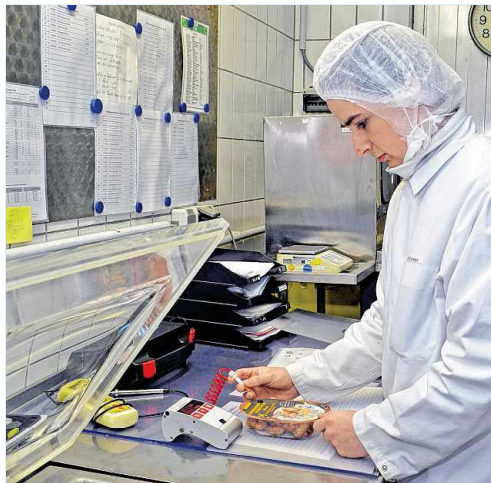
Julian kontrolliert mit einem Messgerät die Dichtigkeit der Verpackung.
